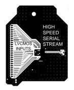
Figure 33. Example DS90UR241-Q1 EMC Layout
