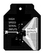
Figure 35. Example DS90UR124-Q1 EMC Layout
