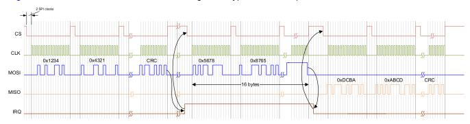
Figure 8-6. SPI Communication
