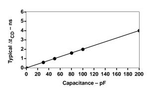
C. LUMPED CAPACITIVE LOAD, TYPICAL DERATING
