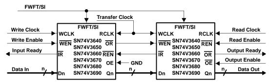
Figure 21. 2048  $\times$  36, 4096  $\times$  36, 8192  $\times$  36, 16384  $\times$  36, 32768  $\times$  36, 65536  $\times$  36 Depth-Expansion Block Diagram
